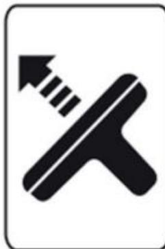
Как только двигатель запускается, нажмите на рычаг воздушной заслонки, с выдвинутой заслонкой двигатель останавливается через несколько секунд.
