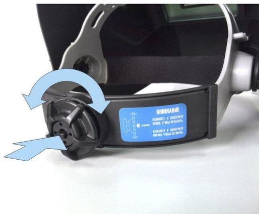
2. *Вертикальная регулировка системы крепления:*
