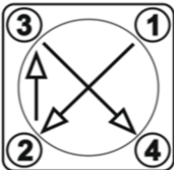
Рисунок 3 - Последовательность затяжки винтов
