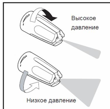
Рис.7. Регулировка угла распыления и силы давления струи
