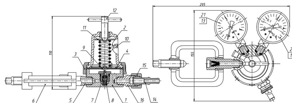
Рис. 1. Редуктор баллонный ацетиленовый одноступенчатый:
