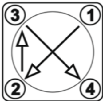
Рисунок 4 - Последовательность затяжки винтов
