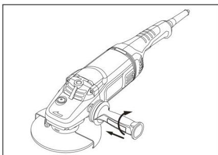
**Внимание!** Все операции по монтажу/демонтажу дополнительной рукоятки выполнять только на отсоединенном от питающей сети устройстве.
