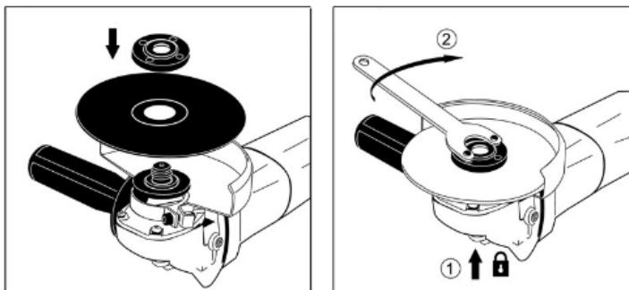
**Внимание!** Запрещается пользоваться кнопкой-фиксатором для остановки вращающегося шпинделя. Это может привести к повреждению устройства!
