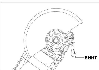
**Внимание!** Все операции по монтажу/демонтажу защитного кожуха выполнять только на отсоединенном от питающей сети устройстве.
