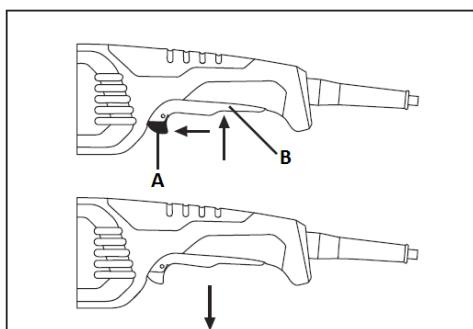
Для **включения** прибора возьмитесь рукой за основную рукоятку, снимите с блокиратора случайного включения А, затем нажмите и удерживайте клавишу включения В. Для **выключения** прибора нажмите и отпустите клавишу В, как показано на изображении слева.
