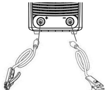
Подключите зажим заземления как можно ближе к месту сварки. Убедитесь, что все соединения надежно закреплены и не болтаются.
