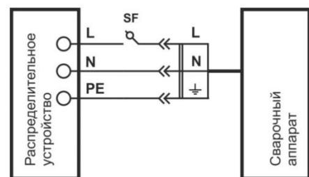
**Примечание:** символ  $\frac{1}{2}$  – обозначение провода заземления. Данный провод имеет желто-зеленую маркировку изоляции.
