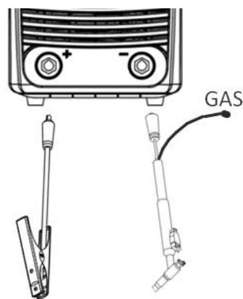
при сварке стали большой толщины, когда необходимы большие токи – дуга легко поджигается и остается довольно стабильной; сварка выполняется постоянным током с прямой полярностью;
