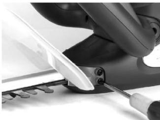
Установите защитный щиток (2) на корпусе кустореза у основания режущего блока (как указано на рисунке). Для этого используйте винты, поставляемые в комплекте с кусторезом. Затяните винты при помощи отвертки или шуруповерта. Периодически проверяйте затяжку данных винтов.
