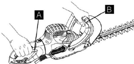
Включение кустореза за счет одновременного нажатия двух выключателей реализовано для того, чтобы пользователь не смог повредить руки о режущий блок.
