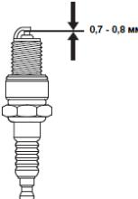
Аккуратно закрутите свечу зажигания руками. После того, как свеча зажигания установлена на место, затяните её свечным ключом.
