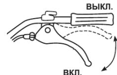
Произведите регулировку рычага с помощью регулировочных гаек. После регулировки запустите мотор и проверьте работу рычага сцепления.
