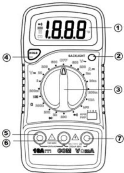
1. LCD дисплей 3,5 разряда отображает результат измерения в цифровом виде.
