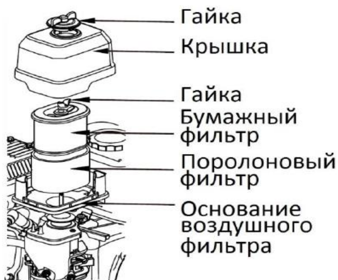
Рис. 7 – Устройство воздушного фильтра
