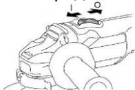
Прежде чем начать работы, всегда дождитесь, когда шлифмашина после включения наберет рабочие обороты. Запрещается включать шлифмашину с заблокированным диском.
