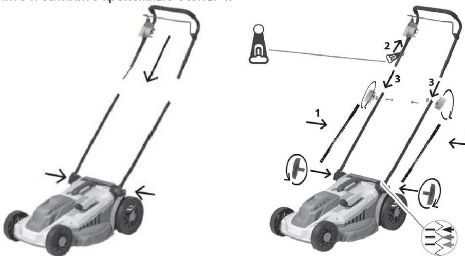
**Внимание!** Крепежные барашки 4 разрешено затягивать только вручную. Запрещается использовать гаечный ключ или другой инструмент, чтобы затянуть их.
