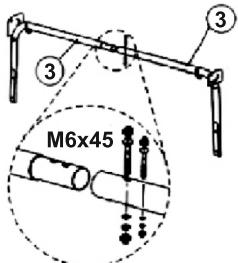
3. Установите боковые дуги для ножек (деталь № 8) с двух сторон между передними и задними опорами, зафиксировав болтами M6x45 и гайками M6.
