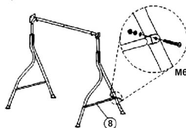
5. Присоедините заднюю дугу для ножек на задние опоры при помощи болтов M6x60 и гаек M6.
