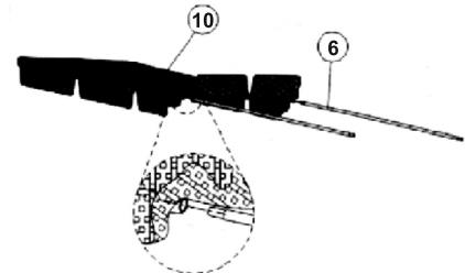
11. Закрепите поперечные дуги тента (деталь №6) с тентом укрывочным (деталь №10) за боковые дуги тента (деталь №5).
