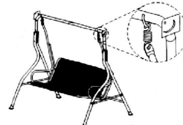
9. Закрепите боковые дуги (деталь №5) для тента (с двух сторон) с помощью болтов M6x25 – гаек M6 и винта (деталь №24).
