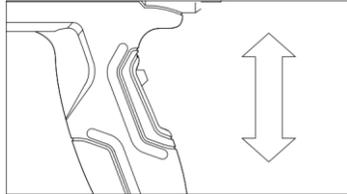
**Внимание!** Прежде, чем выключить инструмент, во избежание опасных ситуаций, для охлаждения термовоздуходувки, сначала сдвиньте выключатель на позицию с отметкой «I», дайте термовоздуходувке охладиться на первой температурной ступени в течение 15 минут, по прошествии указанного временного промежутка сдвиньте выключатель на позицию с отметкой «O».
