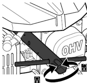
• Проверьте зазор между электродами, в случае необходимости отрегулируйте. Он должен составлять около 0,7-0,8 мм.
