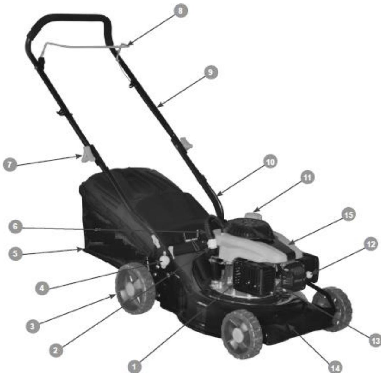
1 – Глушитель; 2 - Масляный щуп; 3 – Колесо; 4 - Рычаг регулировки высоты кошения; 5 – Травосборник; 6 – Ручка стартера; 7 - Гайка крепления рукоятки; 8 - Рычаг остановки двигателя с тросом управления; 9 - Верхняя рукоятка; 10 - Нижняя рукоятка; 11 - Крышка топливного бака; 12 - Кнопка подкачки топлива; 13 - Свеча зажигания; 14 - Корпус (дека) газонокосилки; 15 – Двигатель.
