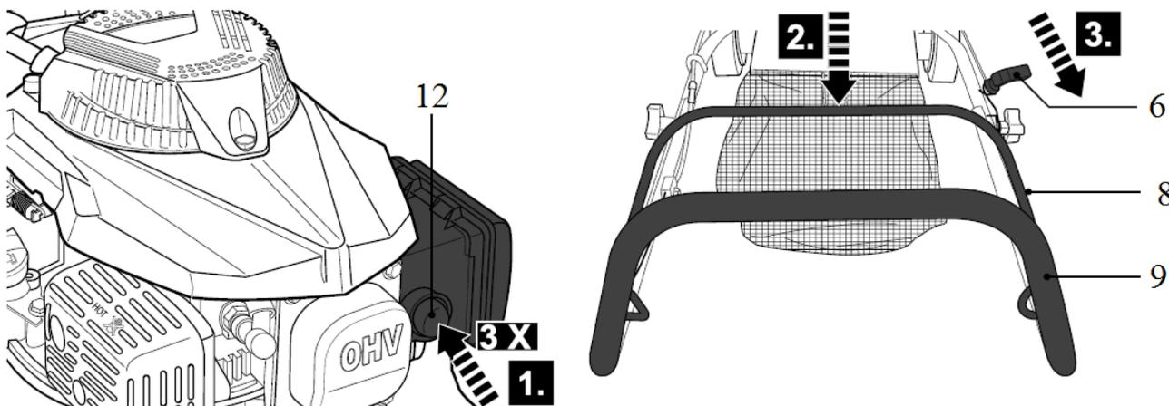
**ПРИМЕЧАНИЕ:** В прохладную погоду может потребоваться повторить вышеописанные шаги по подкачке топлива. В теплую погоду чрезмерная подкачка топлива может стать причиной “затопления” двигателя и он не запустится.
