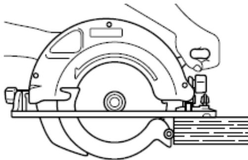
Е) Установите основание 9 на заготовку таким образом, чтобы упор кожуха подвижного касался заготовки. Не позволяйте пильному диску пилы касаться заготовки. При начале резки подвижный защитный кожух 8 уйдет в сторону при перемещении пилы вдоль линии реза.
