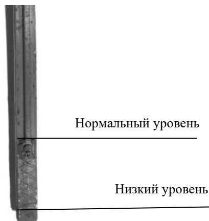
Рисунок 6 – Проверка уровня масла в корпусе редуктора
