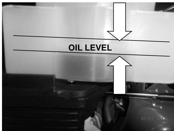
Рисунок 8 – Уровень масла в корпусе воздушного фильтра
