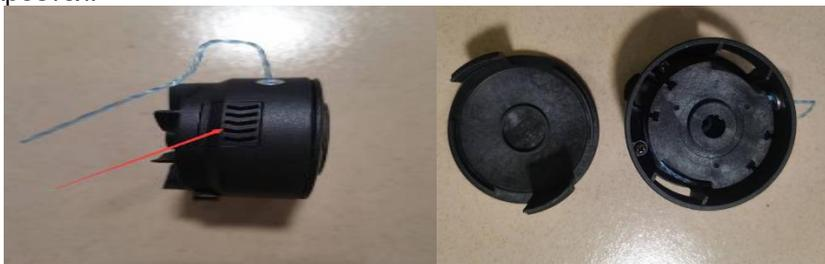
4.2. Затем, следует извлечь кассету, которая находится внутри катушки.
