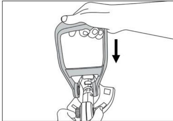
5.2 При необходимости отрегулируйте угол наклона рукоятки. Для этого ослабьте крепежный винт и придвиньте рукоятку на удобный для Вас угол, затем затяните винт по часовой стрелке.
