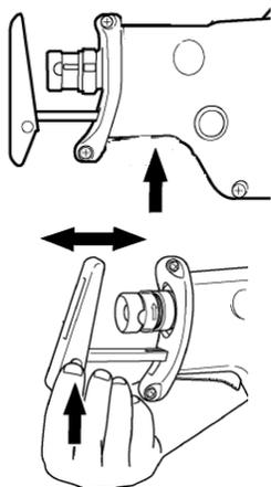
Если эффективность резки пильного полотна снизится, переместите башмак (2), чтобы использовать острую, неиспользованную часть пильного полотна. Это поможет продлить срок службы полотна. Так же, регулировка вылета башмака производится в зависимости от размеров обрабатываемой заготовки.
