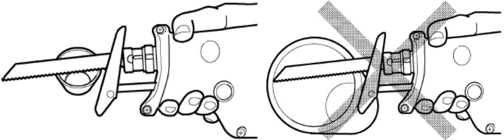
При резке деревянных заготовок больших размеров важно чтобы пильное полотно не ударялось об внутреннюю часть, как показано на рисунке ниже.
