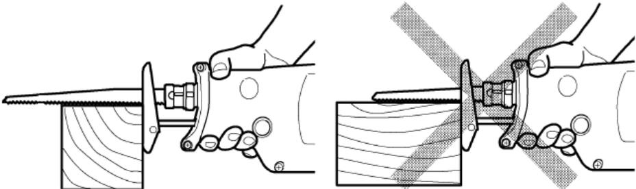
Кроме того, при распиле заготовок, чья толщина (или диаметр) превышает длину пильного полотна, возникает опасность, что пильное полотно застрянет во внутренней
