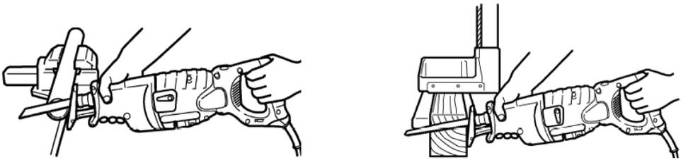
Г) Удобно возьмитесь рукой за рукоятку пилы сабельной. Указательный палец должен находиться на выключателе ВКЛ/ВЫКЛ (4). Второй рукой возьмитесь за корпус пилы в области фиксатора пильного полотна, как изображено на рисунке выше.
