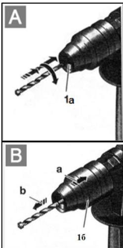
**При установке инструмента обратите внимание на то, чтобы пыльник (1а) не был поврежден.**
