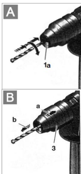
**Рабочий инструмент без хвостовика типа „SDS-плюс”**
