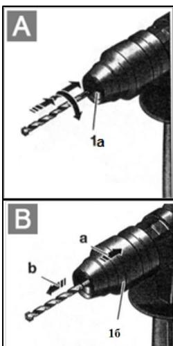
**При установке инструмента обратите внимание на то, чтобы пыльник (1a) не был поврежден.**
