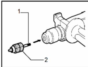
Чтобы можно было работать с инструментами без хвостовика типа „SDS-plus” (напр., для работы сверлами с цилиндрическим хвостовиком), необходимо установить сверлильный патрон кулачкового типа, снабженный хвостовиком типа „SDS-plus” или при использовании специального адаптера.
