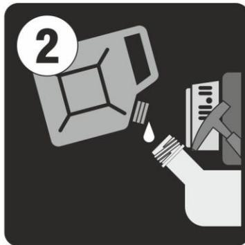
Добавьте топливную смесь в топливный бак
