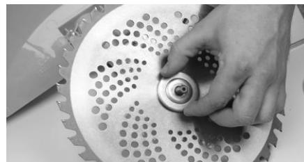
5. Установите на место крышку и гайку, затянув её в направлении против часовой стрелки.
