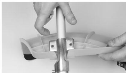
1. Открутите винты и снимите скобу для крепления штанги с кожуха.
