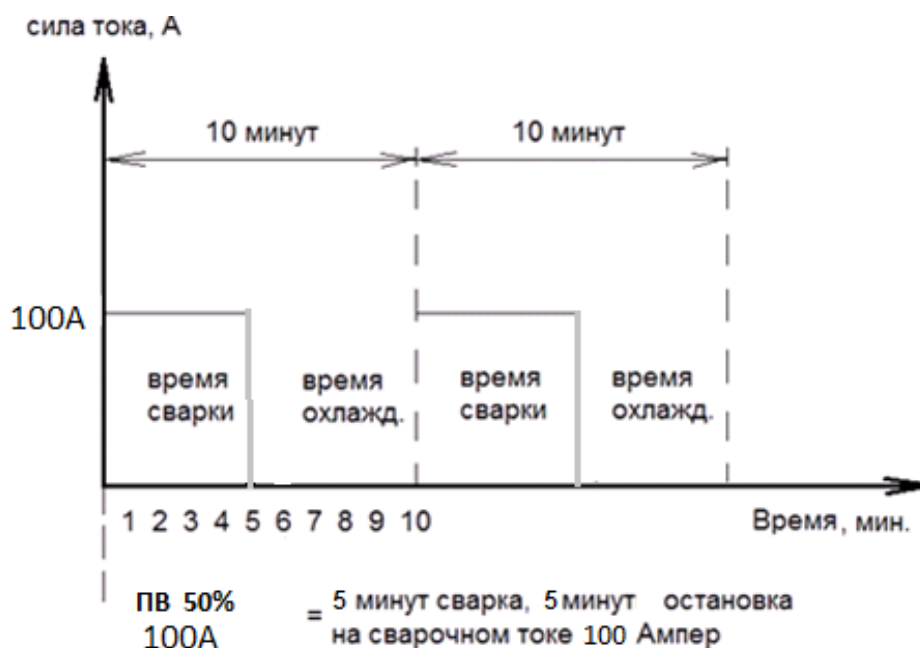
График продолжительности полного цикла работы сварочного генератора
