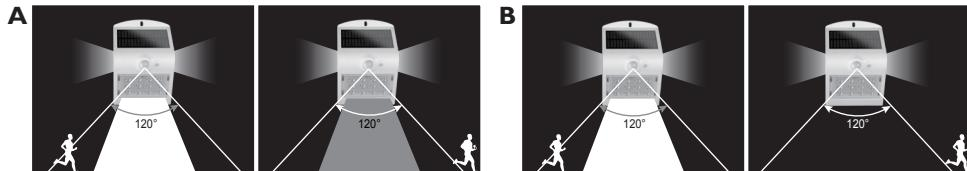
Светильник автоматически начнет светиться только при наступлении темноты. В темное время суток светильник светится от аккумулятора, заряженного в светлое время суток. С наступлением светлого времени суток светильник погаснет.
