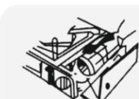
Желоб баллона с газом должен совпадать с гнездом наверху переключателя выключения. Если они не совпадают, то надлежащая установка баллона с газом будет невозможна, и устройство не будет работать.
