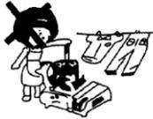
6. Убедитесь в том, что баллон с газом должным образом подключён к клапану газовой плиты. В противном случае возникнет утечка газа. Если вы чувствуете запах газа, НЕ пытайтесь поджечь устройство. Погасите любой открытый источник огня.
