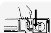
Нажмите на рычаг фиксации и переведите его в нижнее положение. Примечание: баллон с газом не может быть зафиксирован, если поддон расположен вверх дном.
