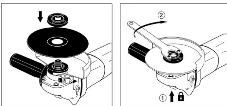
**Внимание!** Запрещается пользоваться кнопкой-фиксатором (1) для остановки вращающегося шпинделя. Это может привести к повреждению устройства! После установки рабочей оснастки убедитесь, что оснастка вращается легко и ничего не задевает. Проверить это можно путем вращения вручную оснастки. Всегда при замене/установке дисков очищайте от грязи шпиндель, посадочную шайбу, прижимную шайбу, кожух, диск.
